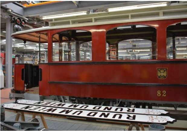
Bei der Komplettierung und Dachtafelmontage
