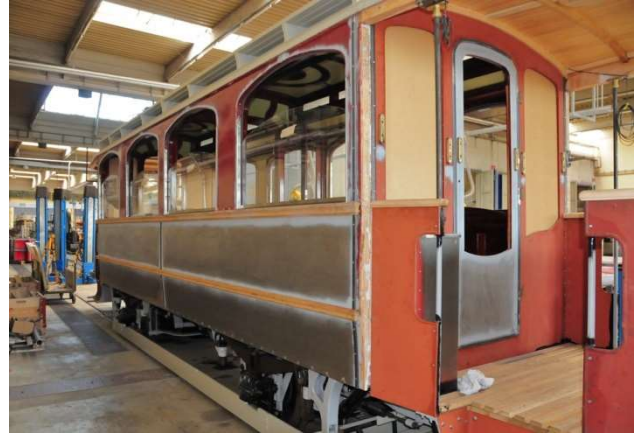
Nach erfolgter Montage der Seitenwandbleche.
